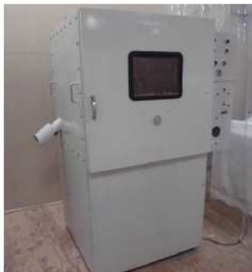
小型粉塵試験機 槽サイズ: W1000 × H1000 × D1000 (mm) 扉開口: W800 × H800 × D1000 (mm)
