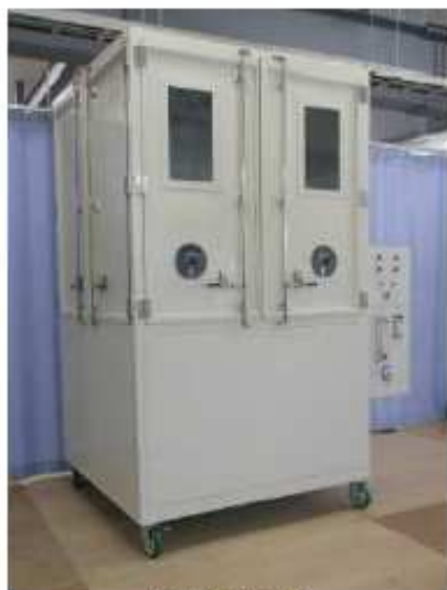
大型粉塵試験機 槽サイズ: W1500 × H1500 × D1500 (mm) 扉開口: W1400 × H1400 × D1500 (mm)
