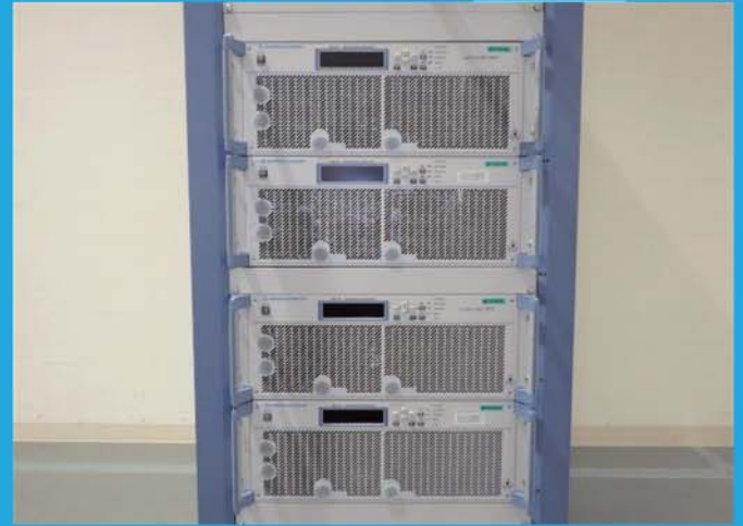
アンプ : 試験周波数6GHzまで試験対応 MODEL: BBA150- D400 0.69 - 3.2GHz 400W BBA150- E400 2.5 - 6GHz 400W
